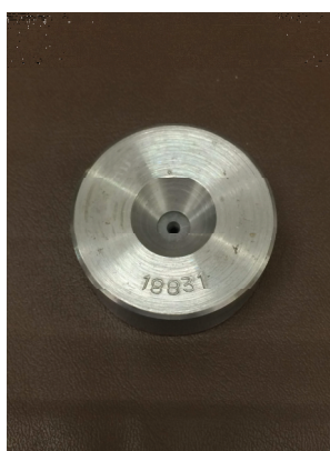
ダイス裏（丸線を引き抜く面）
